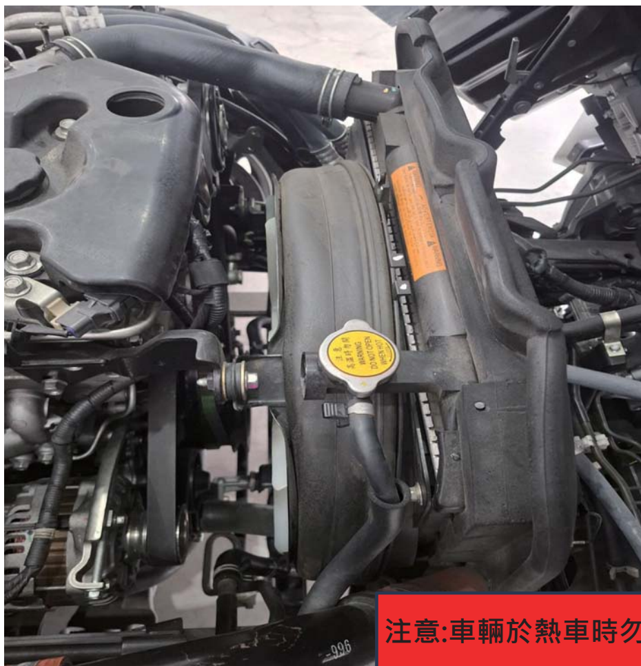
⑰水箱水確認-水箱蓋正確位置
