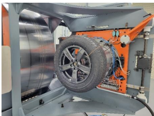
圖六:輪胎滾動阻力試驗機
