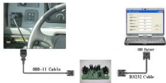
圖 1 OBD II 轉換 RS232 資料擷取模組架構 由車輛 OBDII 取得之車輛資訊設定為每秒 5 筆資料。
