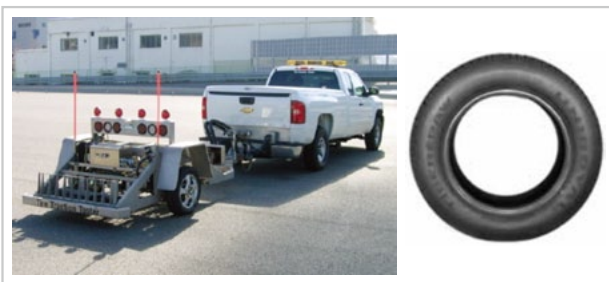
▲ 圖5、濕地抓地力專用拖車與SRTT輪胎
