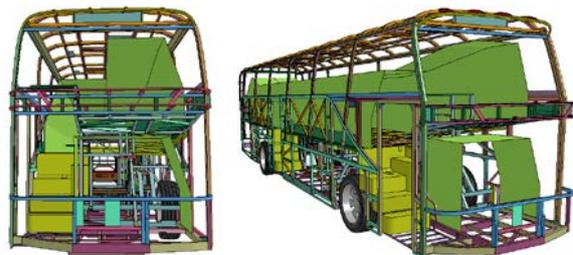
圖 6 整車有限元素模型
