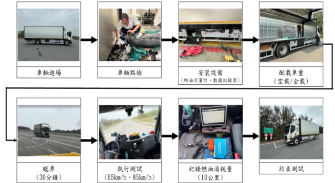
圖 1 燃油大貨車測試流程示意圖
