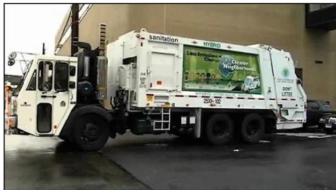
圖 3-3 HRB 系統安裝於 26 公噸之垃圾車於紐約市實測[5]
