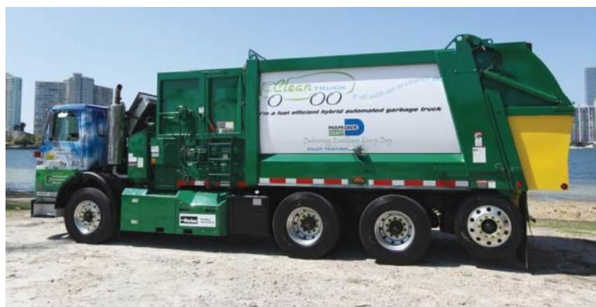
**圖 3-6 Parker Hannifin 與 AutoCar 公司液壓混合動力車輛圖[7]**
