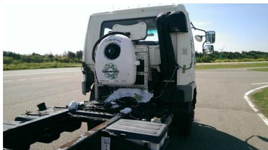
圖 2 駕駛艙電動空調於 FUSO-11 噸測試車安裝
