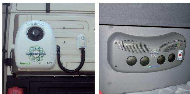
圖 1 電動駕駛艙空調系統[3-4]
