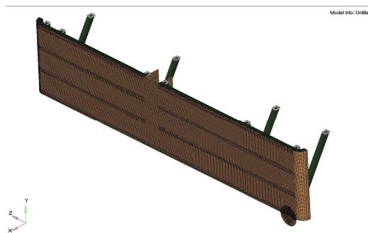
圖 17 側方防止捲入裝置結構與空力套件側裙有限元素模型
