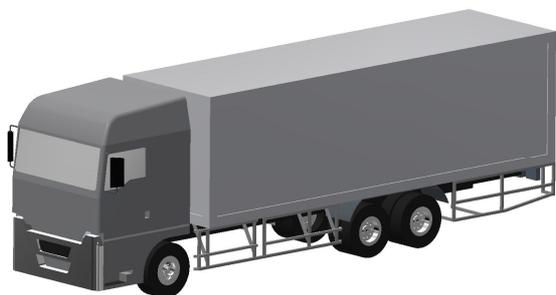
圖 6 整車側方防止捲入裝置外觀圖
