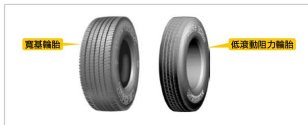
▲ 圖3、低滾動阻力輪胎(右)及寬基輪胎(左)<sup>[9]</sup>
