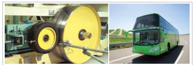
▲ 圖6、輪胎滾動阻力與實車油耗測試
